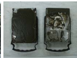
泥水で汚れたHDD
